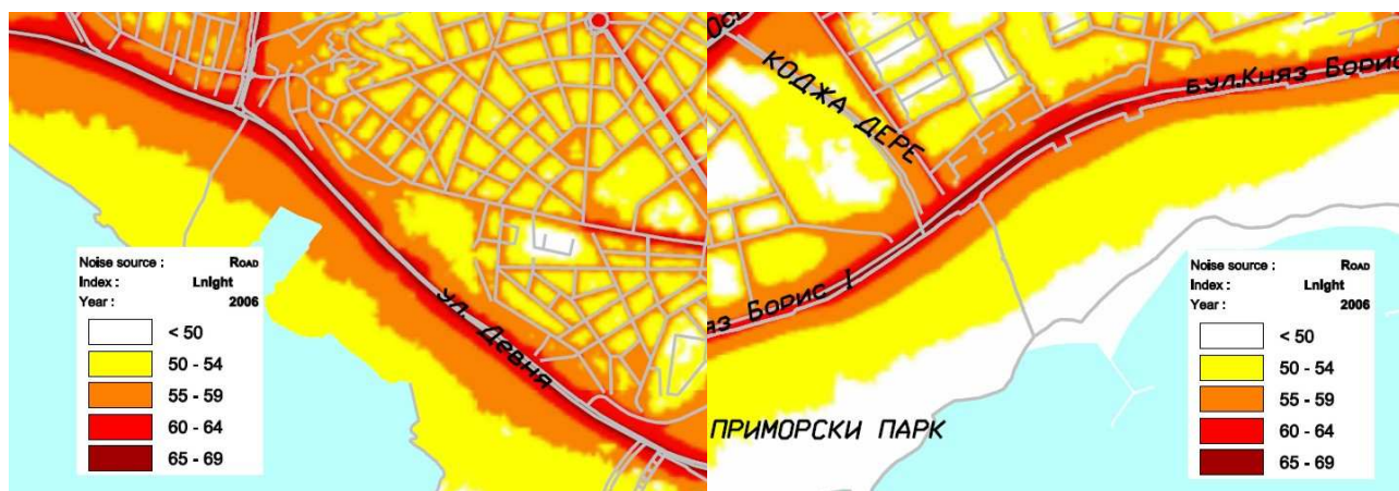
Фиг. 5.3 Шумова карта общ. Варна: а) бул. „Девня“, ниво на шума от пътен трафик през нощта L_{den} ; б) „Приморски парк“, ниво на шума от пътен трафик през нощта L_{den} ;
