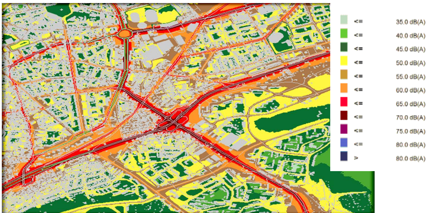
Фиг. 1: Графична визуализация на показателя Лнощ от СШК за агломерация Русе, с включени всички видове изследван шум (автомобилен, железопътен, авиационен и промишлен)
